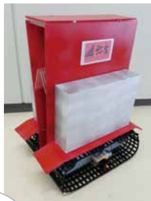
▲◀棚田用の稲刈り機「弥生2号」の試作機と、そのCGデザイン。耕作機械を使用することが難しい棚田で、効率よく稲刈りができないかと考え、パソコンでのデザインが得意な友人、メカニックが得意な友人などと協力して実現化した
