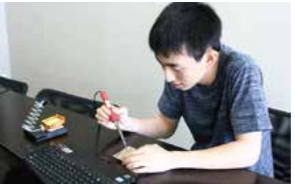
▲パーツを基板上にハンダ付けしながらキットを自分で組み立てる。出来上がったパソコンにつないでプログラムを入力すると、LEDが点灯する
