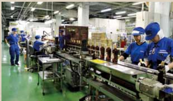
(右)充填の行程では、1分間に約150本のビン詰めが行われる (上)工場ではウイスキー以外にも焼酎や缶チューハイ、カクテルなどさまざまなパッケージングを行っているが、「竹鶴」などの高級品は、異物やラベルのチェックを5〜6人の人手をかけて行っている
