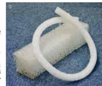
②運動マット用クッション材を、タイヤのチューブに合うよう円柱状に長く加工。カッターなどで簡単に切断できるため、どんなタイヤの大きさにも適合する。また、太さは4種類あり、市販の主な自転車(軽快車・子ども用・車いすなど)のすべてに適合する
