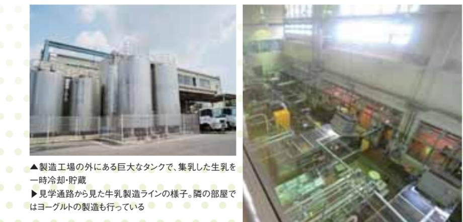
▲製造工場の外にある巨大なタンクで、集乳した生乳を一時冷却・貯蔵
