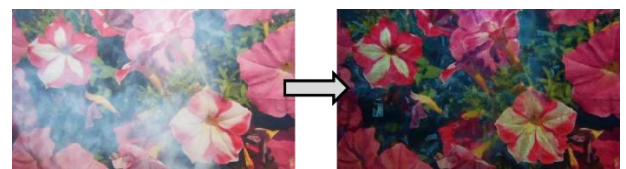
図 2：ドローン映像の煙除去 (視認性が向上し、画像認識精度向上につながる)
